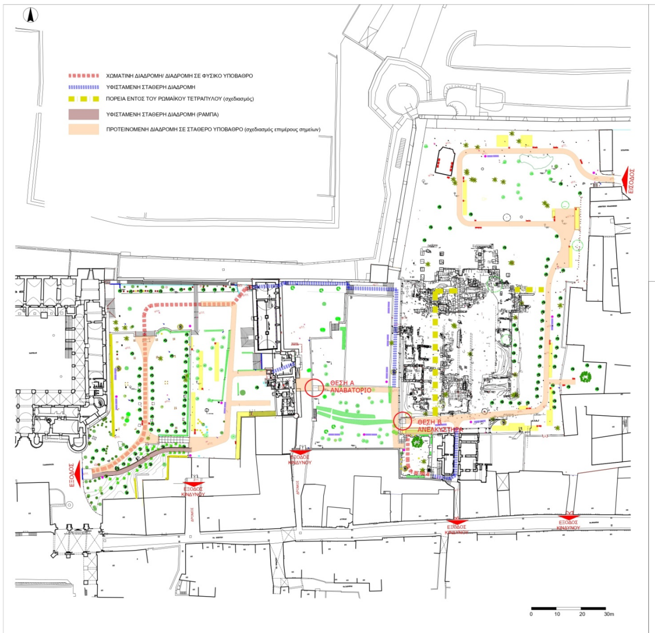
Εικ. 2: Τοπογραφικό Διάγραμμα του υπό διαμόρφωση αρχαιολογικού χώρου της Περβόλας, όπου σημειώνονται με η θέση του αναβατορίου και του ανελκυστήρα.
